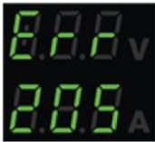
Das in der Grafik links dargestellte Beispiel zeigt an, dass die Versorgungsspannung in der Stromquelle fehlerhaft ist.
